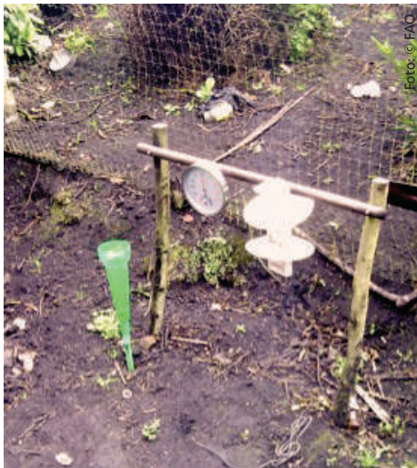
Figura 8.- Instrumentos de medición de clima (termómetro de max. y mínimas, higrómetro y pluviómetro): entregado a cada uno de los integrantes del proyecto.
