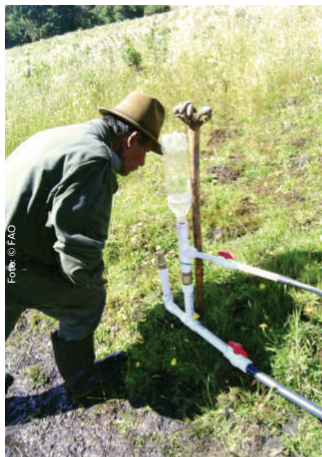
Figura 11.- Bomba de ariete Modulo demostrativo para replica por parte de los participantes.
