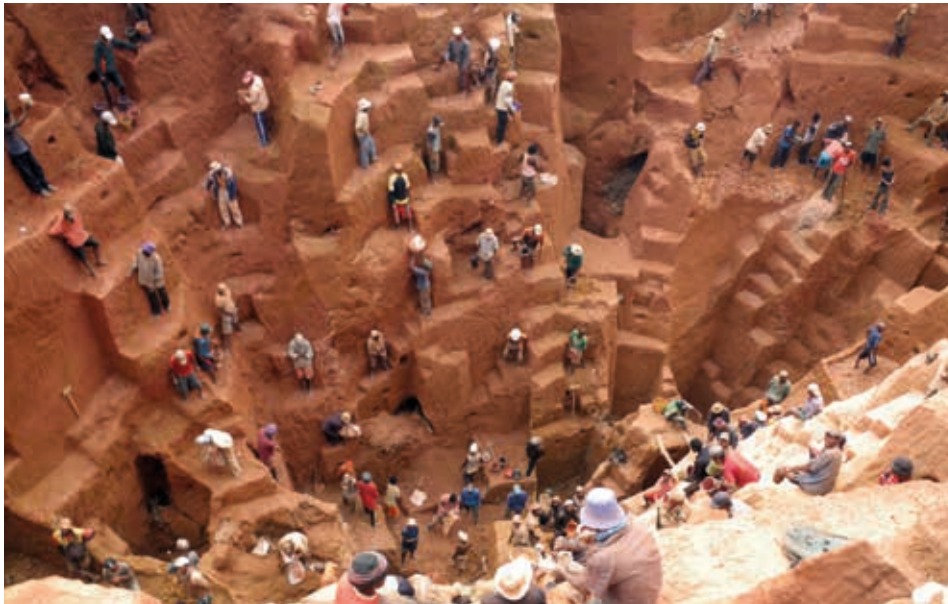
Mina de oro artesanal a cielo abierto en las tierras altas de Madagascar. La mina era explotada por grupos de personas, con frecuencia familias, y fue escena de numerosos accidentes fatales al derrumbarse los pozos junto al sistema de terrazas.
